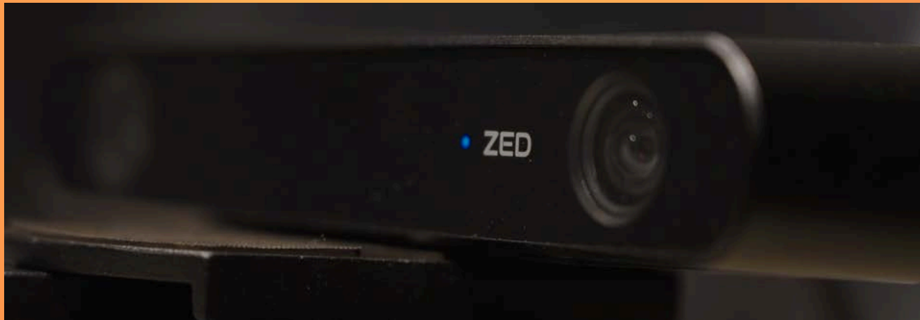
Caméra à profondeur de champ, ZED. Crédit photo :Francisco Cruz, Les 7 Doigts
