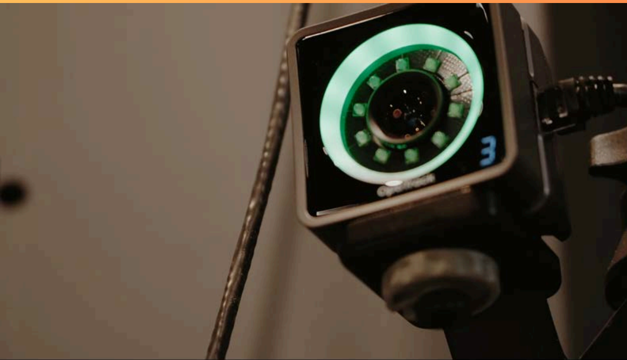
Exemple d'une caméra infrarouge pour le système Optitrack.
